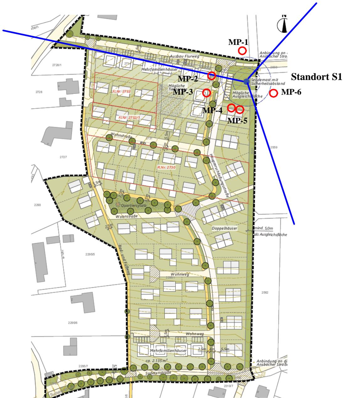
Abb. 1 Lage des Standortes S1 und Hauptabstrahlachsen HSR (blau) mit den lokalen Rechenpositionen
