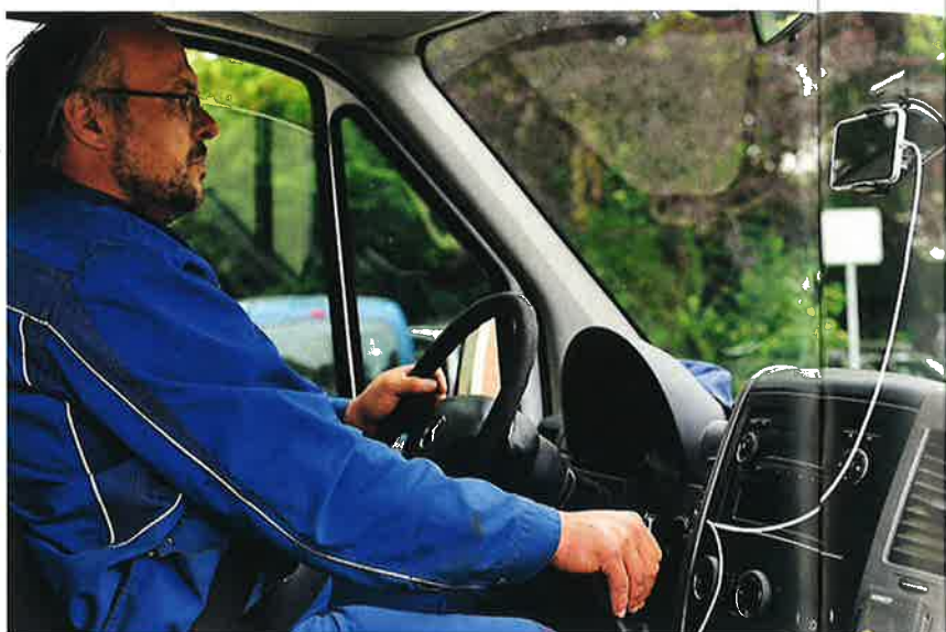
Während eines üblichen Einsatzes erfassen Bauhofmitarbeiter quasi nebenbei mit Vialytics in einem Smartphone den Zustand der Straßen.
